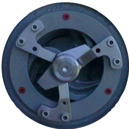
**Sistema triturador** elemento indispensable para las interrupciones de funcionamiento en cuando la aplicacion de las bombas con hidroeyectores en los residuales sin filtrados y los lodos.
