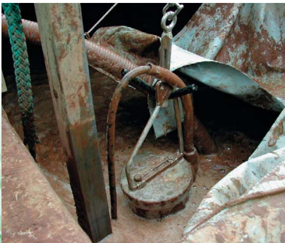
Bomba sumergida AirJet para el estiércol.
